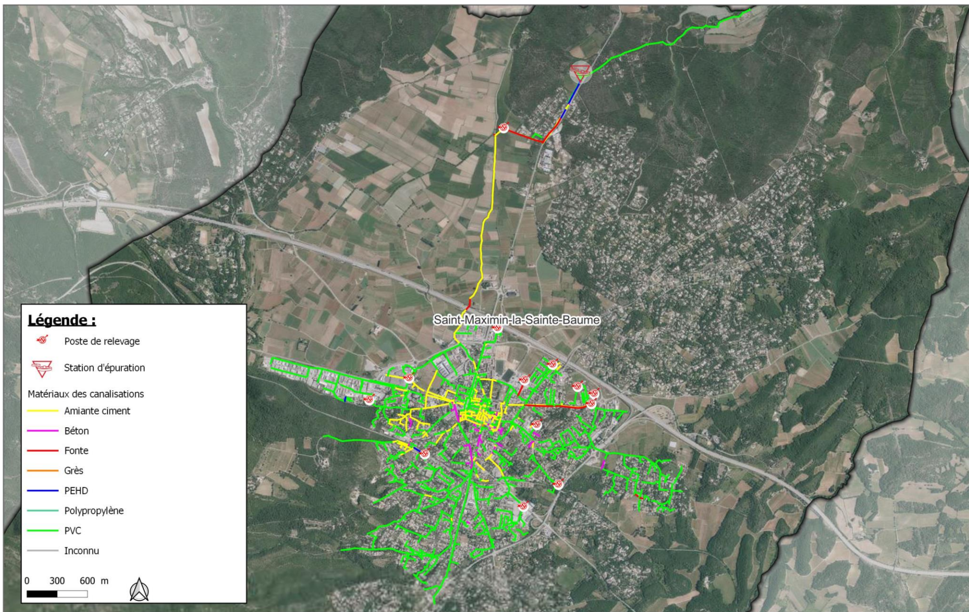
Figure 4 : Réseau d'assainissement - type de matériau
